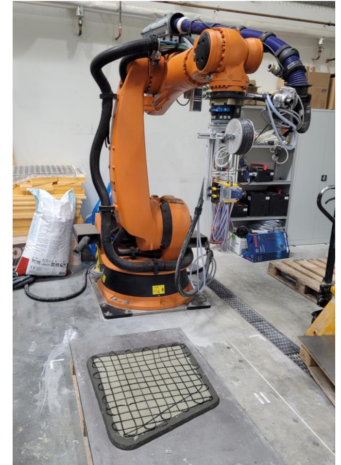
Robotische Verlegung von Carbongarn
